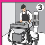
3. При машинном нанесении приготовьте раствор в штукатурной станции. Расход воды 600-700 л/час.
