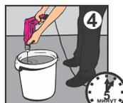
4. При ручном нанесении перемешайте раствор дрелью со специальной насадкой на низких оборотах, засыпая сухую смесь в воду до получения однородной массы. Подождите 5 минут, после этого перемешайте повторно. Время пригодности раствора к работе не менее 1 часа.
