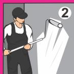
2. Обработайте основание грунтовочными составами БОЛАРС, соответствующими Вашему типу поверхности.
