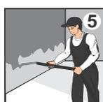
5. Используя штукатурную станцию, нанесите раствор на стену. Толщину слоя регулируйте уменьшая или увеличивая скорость перемещения штукатурного пистолета вдоль стены. При ручном нанесении «набрасывайте» штукатурку мастерком или нанесите кельмой слоем от 5 до 40 мм. В случае необходимости применения штукатурных маяков, установите их параллельно друг другу на расстоянии 15-20% от ширины правила.
